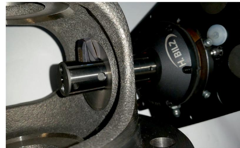
**1** Fit für die Großserie mit der Perspektive Industrie 4.0: ein schneidenüberwachtes, intelligentes Rückwärtssenk-Werkzeug der Ausführung ›Autofacer‹ bei der Bearbeitung von Formelementen eines Differentialgehäuses (© Hermann Bilz)
