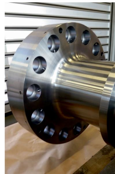
**3 Senken mit hohem Anspruch heißt die Devise, wenn die Flansche von Generatorenwellen fertigbearbeitet werden sollen** (© Hermann Bilz)
